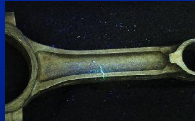
Fluoriserende penetrant indikasjon
